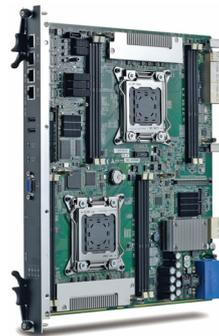
Платы ATCA имеют размер 280×322 мм, позволяют устанавливать до двух процессоров типа Intel Xeon, стандартные модули памяти DIMM и отводить до 350 Вт тепловой мощности принудительной вентиляцией
